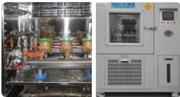
Máy tạo độ ẩm ổn nhiệt (Máy kiểm tra mức độ chống đóng băng của đồng hồ nước)
