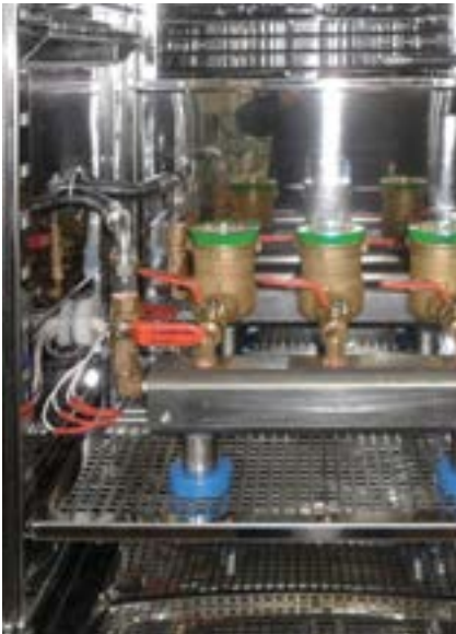
Quy trình kiểm tra chống đóng băng của đồng hồ nước với nhiệt độ và độ ẩm không đổi
