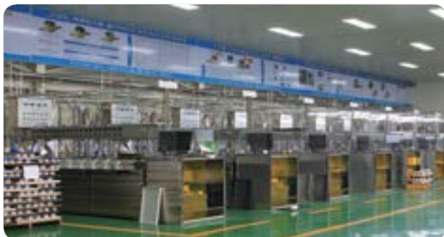
Kiểm tra đồng hồ nước hoàn toàn tự động 1.6 (bộ số của 100 đến 200) bàn kiểm tra chức năng cân & đo hoạt động (15 đến 50 mm)
