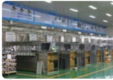
Kiểm tra đồng hồ nước hoàn toàn tự động 1.6 (bộ số của 100 đến 200) bàn kiểm tra chức năng cân & đo hoạt động (15 đến 50 mm)
